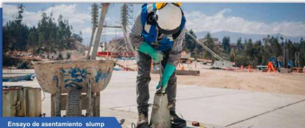
Elaboración y curado de probetas
